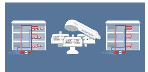
*Sofortmaßnahmen – Fortsetzung des Betriebes der Trinkwasser-Installation mit endständigen Wasserfiltern*
